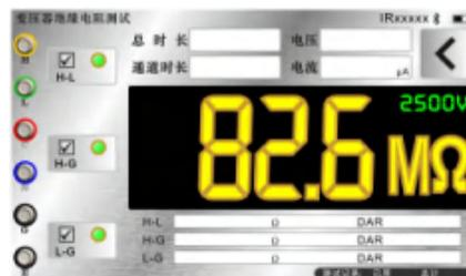
(变压器绝缘电阻测试界面)
