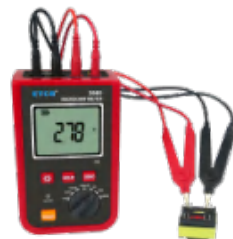
变压器线阻测量
