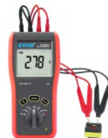
变压器线阻测量
